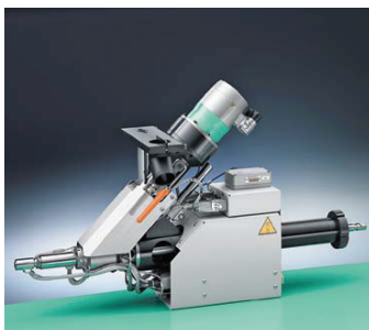
Um reproduziergenau nach dem First-in-first-out-Prinzip zu arbeiten, kombiniert das Mikrospritzmodul von Arburg eine 8-mm-Schnecke zum Einspritzen mit einer zweiten Schnecke zum Aufschmelzen von Standardgranulaten Foto: Arburg
