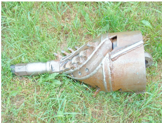
Abbildung 3: Räumer mit Drehadapter
